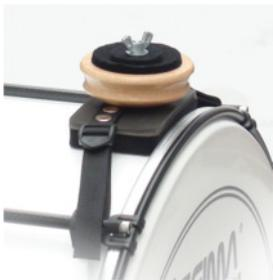
Alle Lefima-Beckenhalter besitzen eine spezielle Isolierungshülse im Innern, die einen Kontakt des Beckens mit der Befestigungsschraube und somit störende Vibrationsgeräusche verhindert. Die Fixierung des Beckens erfolgt über eine selbstsichernde Flügelmutter, die sich auch dann nicht lösen kann, wenn sie nur locker angezogen wird.
